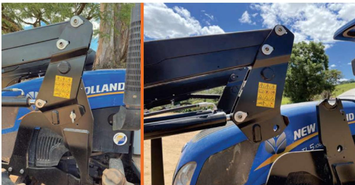
Uno de los puntos fuertes del Quicke V es precisamente la practicidad de acoplar y desacoplar el conjunto al tractor.
