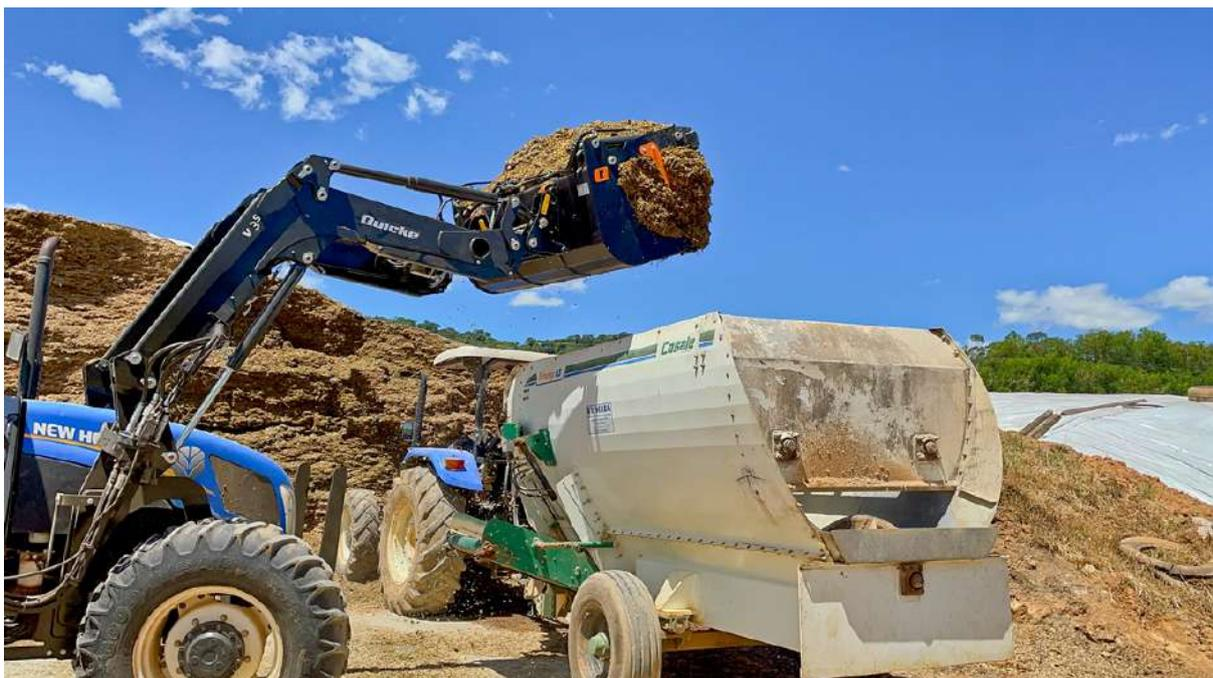
La Multibenne M+ es una horquilla utilizada para descargar y cargar ensilado.
