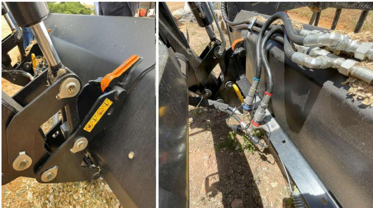
Detalle del acoplamiento rápido (izquierda) y de las terceras conexiones de control (derecha)
