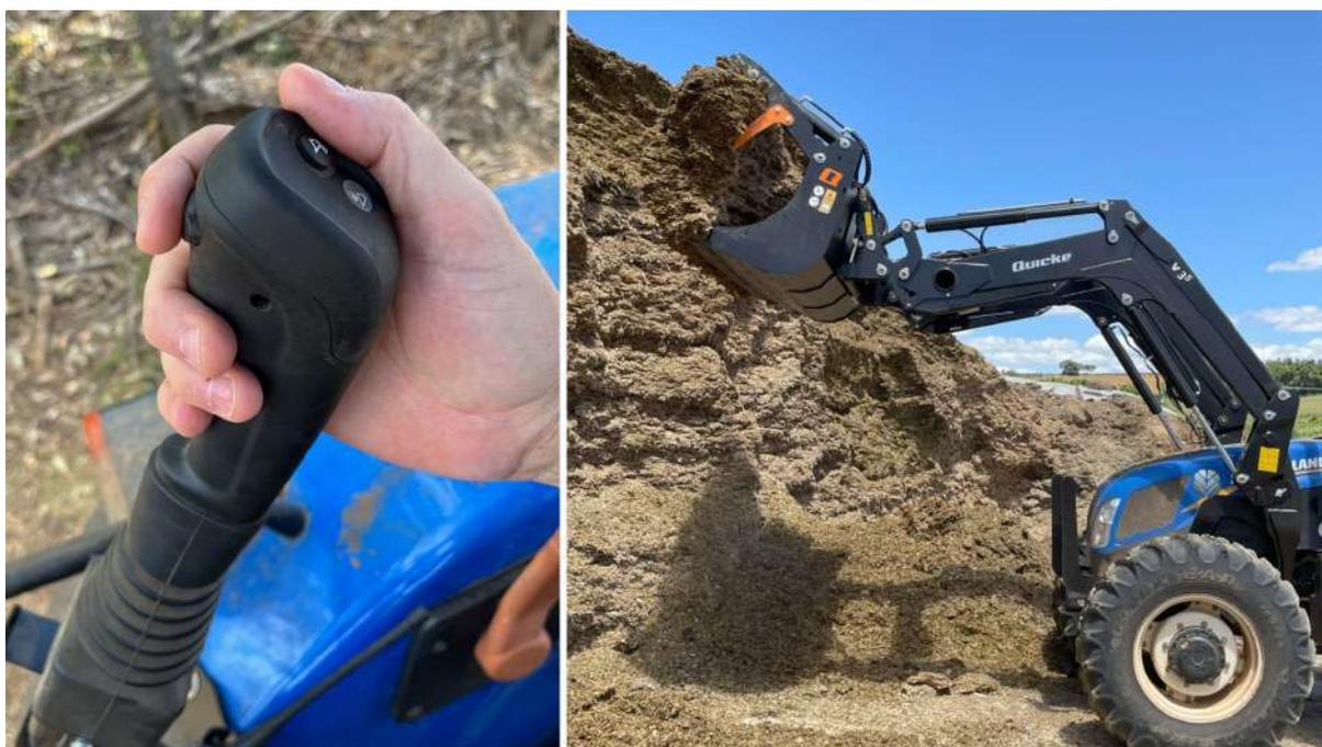
Un solo "joystick" controla todas las funciones del cargador frontal y los implementos acoplados. Un botón en la parte frontal permite realizar más movimientos cuando el implemento tiene una tercera función, como por ejemplo el Multibenne M+.
