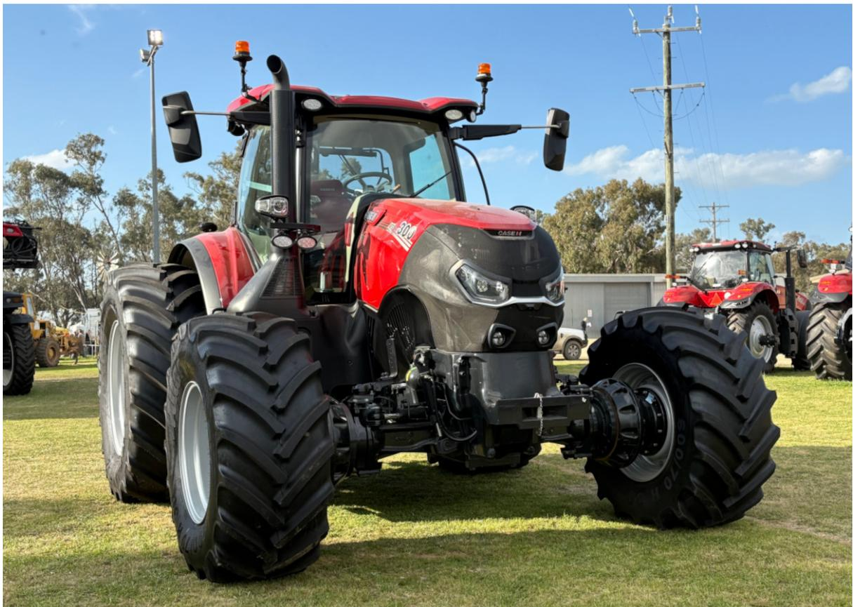
A Case IH apresentou no Henty Machinery Field Days sua nova configuração com bitola de três metros para a linha de tratores Optum. O lançamento atende agricultores que adotam o sistema de tráfego controlado (CTF), prática crescente na Austrália.
