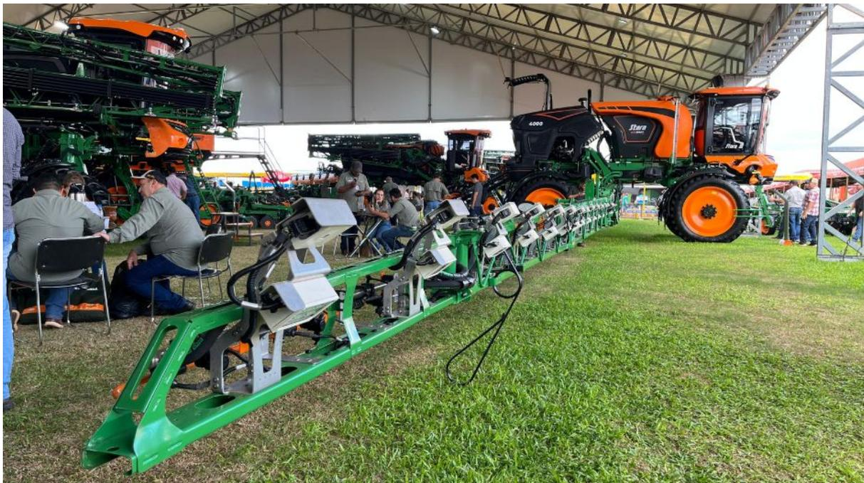
Stara destaca su tecnología de pulverización localizada, Eco Spray, en la Feria Rural Coopavel 2025, evento que se realiza hasta el 14 de febrero en Cascavel (PR). Integrado con los pulverizadores Imperador 3000 y 4000, el sistema utiliza sensores y cámaras para identificar malezas y aplicar pesticidas sólo donde sea necesario, reduciendo el uso de productos químicos hasta en un 95%.
