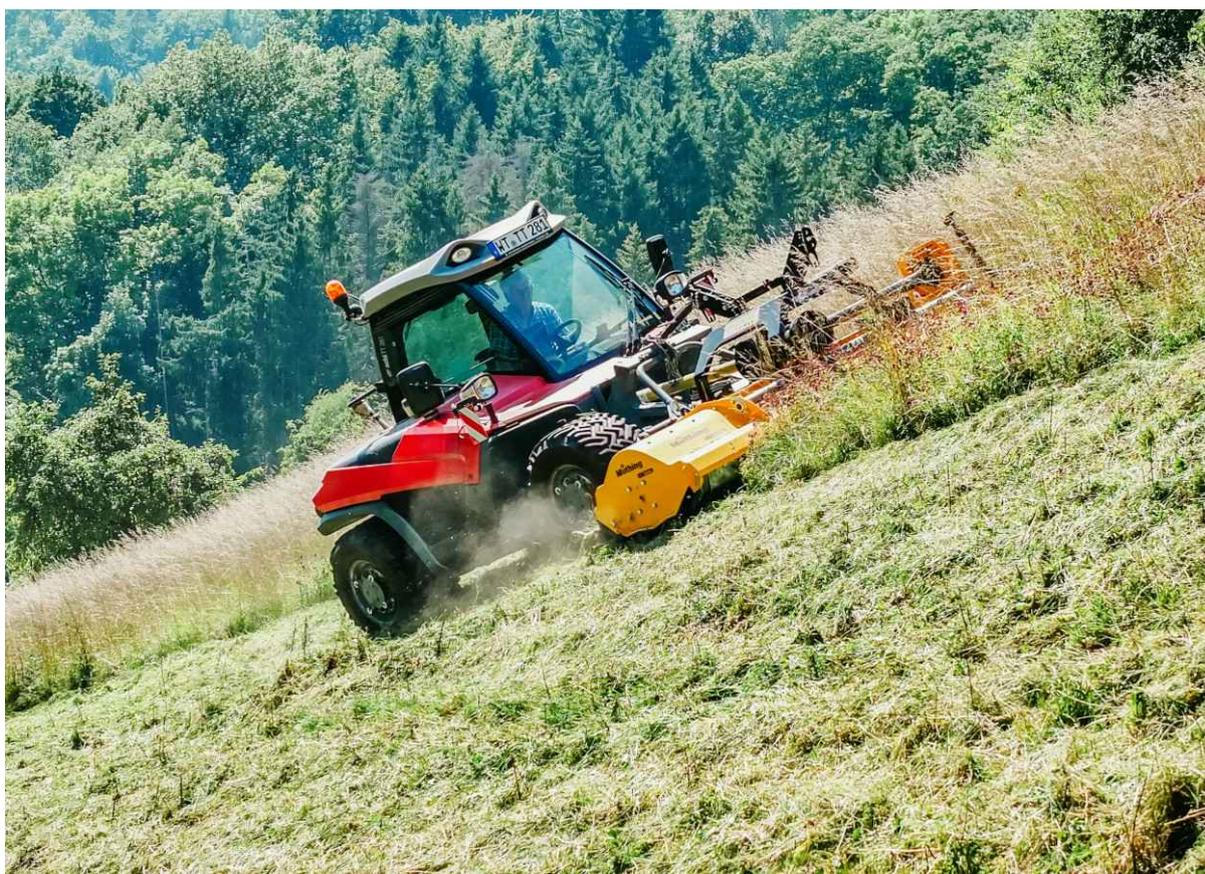
O conceito elimina diferenciais convencionais e distribui a tração por meio de transmissões planetárias com controle hidrostático individual por roda. A tecnologia mantém a velocidade ideal de cada roda em curvas, aumenta a segurança em terrenos inclinados e reduz danos ao solo.
