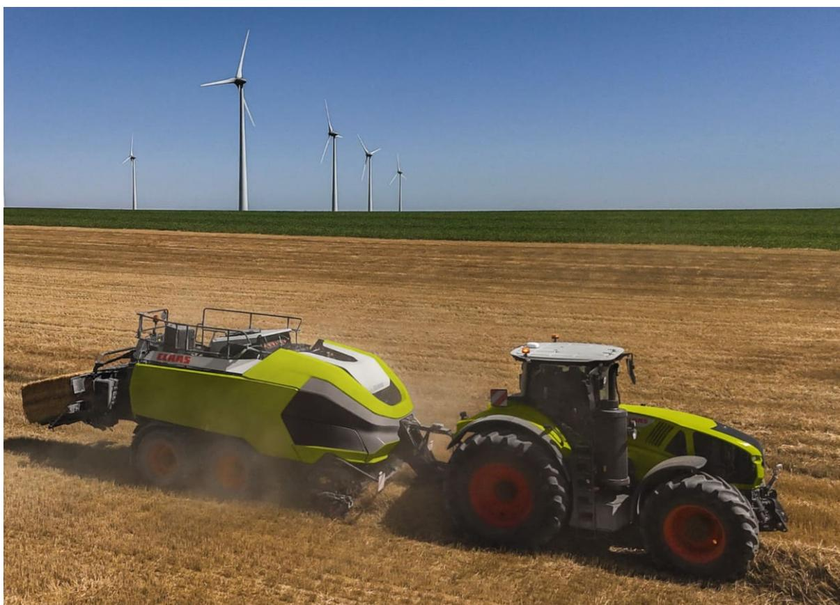
A máquina ajusta automaticamente o comprimento e peso dos fardos com precisão de até 2%. A solução visa alta
