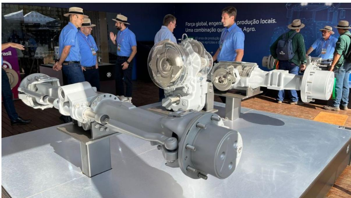
No estande de 300 m<sup>2</sup>, a ZF apresenta ainda uma linha completa de soluções para o agronegócio, incluindo o eixo TSA23, com kit reversível de bitola para atender à cultura da cana-de-açúcar, e a transmissão TPT 20, desenvolvida para tratores de até 205 HP, com destaque para a função Intelligent Range Shift e operação a até 50 km/h com baixa rotação do motor.
