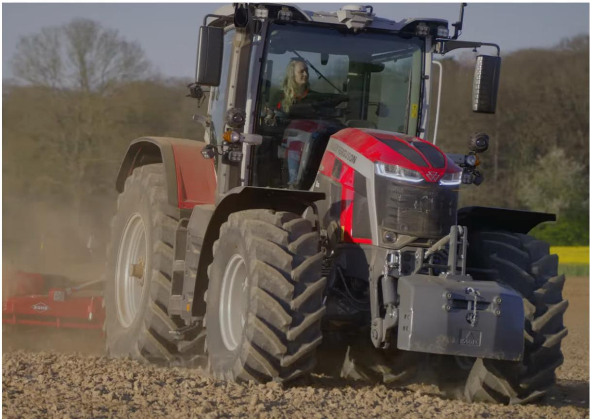
Entre las características técnicas, la serie Xtra incluye un sistema de refrigeración mejorado con control del ventilador que aumenta la eficiencia hasta en un 5 % y reduce el consumo de combustible. Un ventilador reversible opcional garantiza la limpieza del sistema incluso en entornos con mucho polvo.
