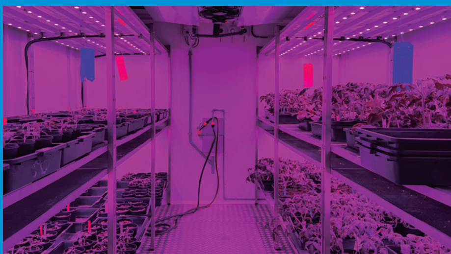
Interior da câmara de crescimento, ambiente com controle de luz e temperatura onde os experimentos foram realizados. O uso deste sistema garante que as plantas cresçam sob condições padronizadas, permitindo avaliar com precisão a evolução do vírus
