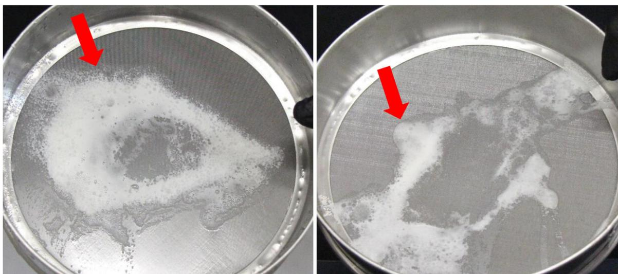
Ejemplo de problema de compatibilidad de mezclas con gli wg1 + 2,4-D a dosis de aplicación de 40 L/ha (a) y 80 L/ha (b) con residuos similares a espuma, sobre tamices de malla 100.
