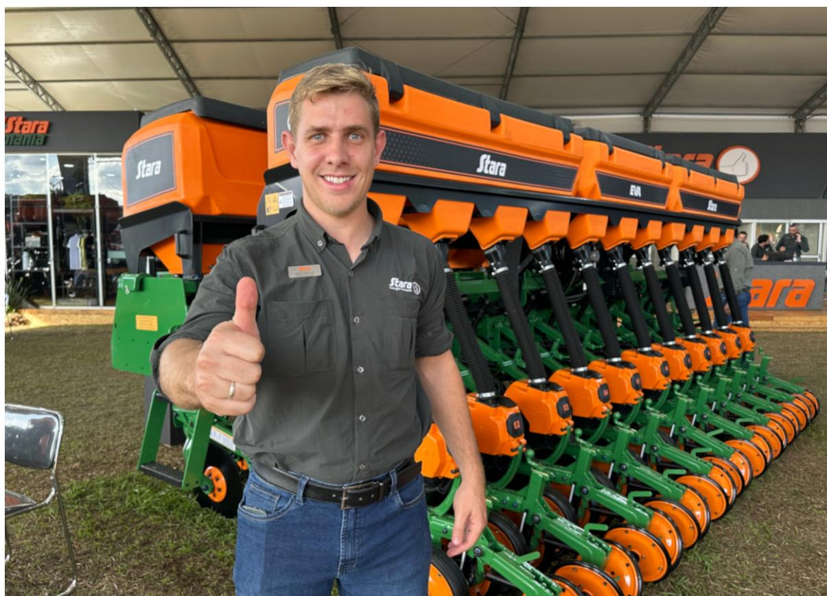
A linha de sementes da Eva possui distribuição precisa, com dosador elétrico DPS-E e sete pontos de eliminação de sementes duplas. Já o sistema Fertisystem assegura uniformidade na aplicação de fertilizantes. As linhas pantográficas com rodados independentes garantem melhor copiagem do solo.
