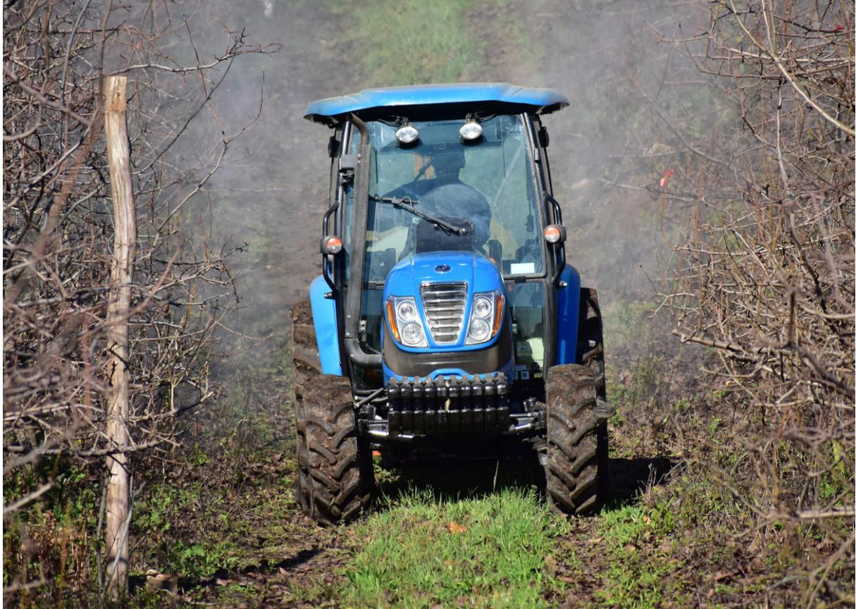
Guardadas as diferenças construtivas, na prática os pneus radiais e especialmente os BPAF, quando devidamente montados e inflados apresentam vantagens de causar menor compactação dos solos, patinagem e consumo específico de combustível e maior capacidade de tração,
