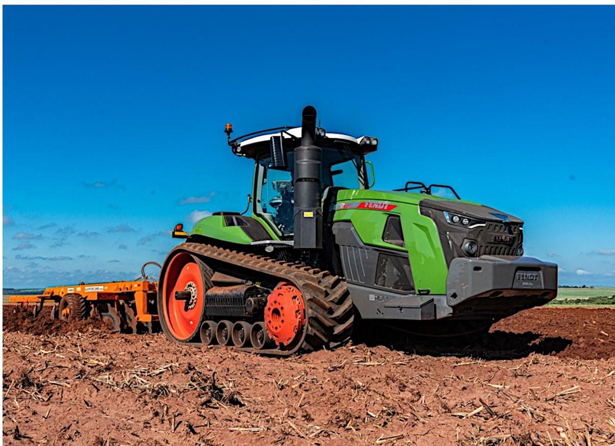
Em função da presumível maior área de contato das esteiras, os tratores com elas equipados tendem a apresentar maior capacidade de tração em virtude da redução da patinagem e melhor eficiência da transferência de potência e interação rodado/solo. Essas características propiciam aos tratores esteirados maior
