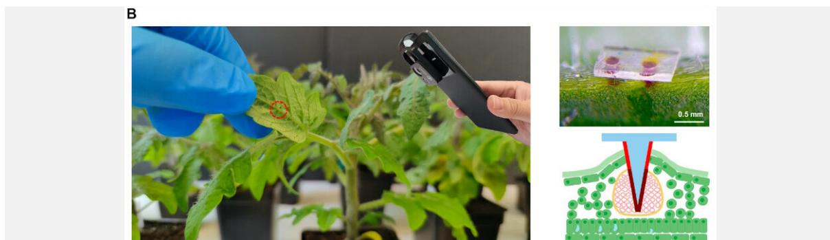
**(B)** fotos e ilustrações das microagulhas injetadas na nervura central da folha de uma planta de tomate de 6 semanas para monitoramento do pH da seiva vascular
