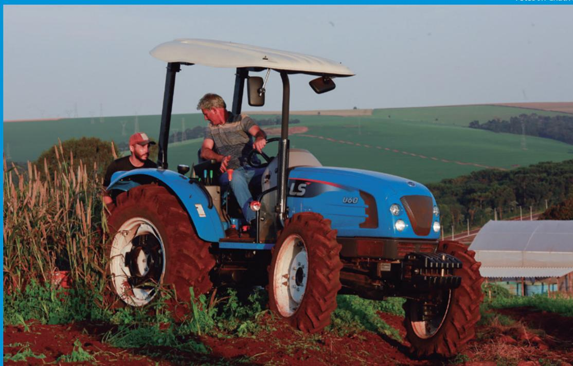
A transmissão com 32 velocidades do tipo Synchro Shuttle com 32 velocidades à frente e 16 à ré, com super-redutor Creeper, é um dos pontos altos do U60
