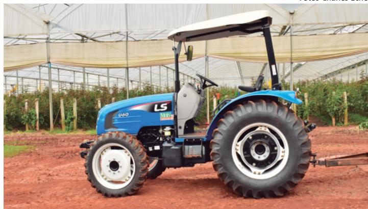
A potência máxima é de 65cv, segundo a Norma ISO TR 14396, obtida a 2.600rpm. O torque máximo é de 203Nm a 1.600rpm
