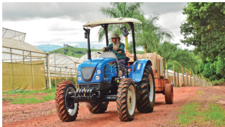
É um trator de porte médio-pequeno, com motor marca LS, modelo L4AL-T1 - Tier 3, de quatro cilindros
